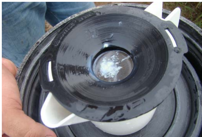
Fig. 1. Teste da caneca de fundo escuro ou telada com presença de grumos, Rondon do Pará, PA.
